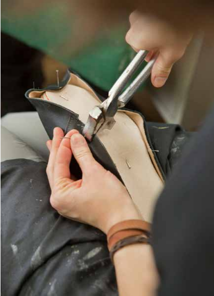
Abbildung 4: Zwickeln eines Schuhs (Quelle: fotogloria/ZVOS)
