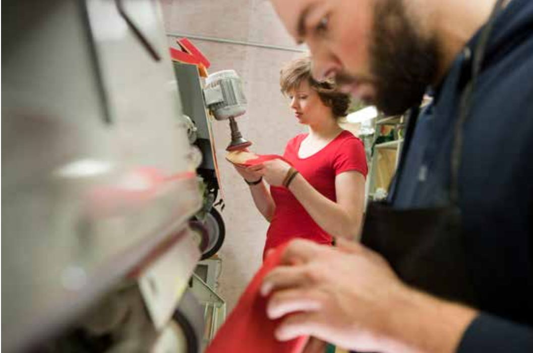
Abbildung 10: Einlagen schleifen (Quelle: fotogloria/ZVOS)
