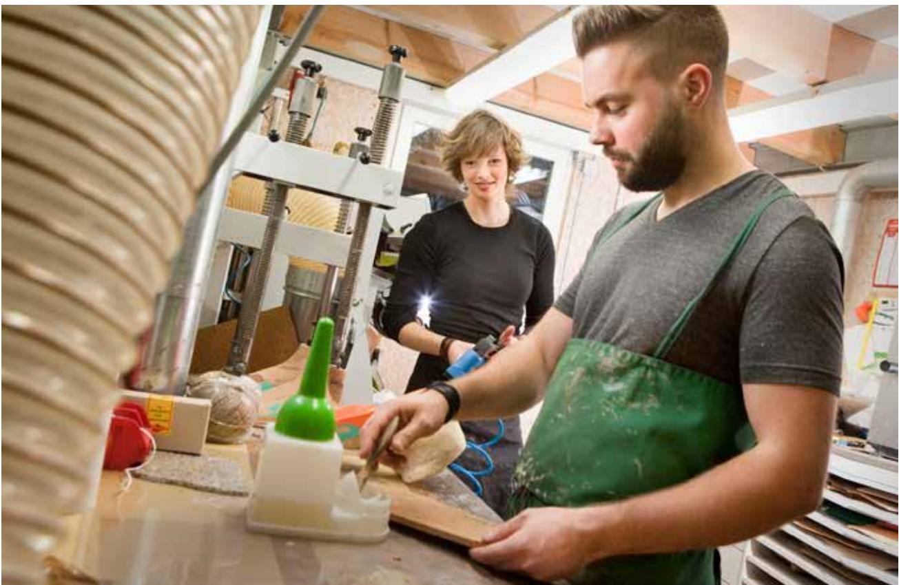
Abbildung 13: Verkleben von Korksohlen (Quelle: fotogloria/ZVOS)
